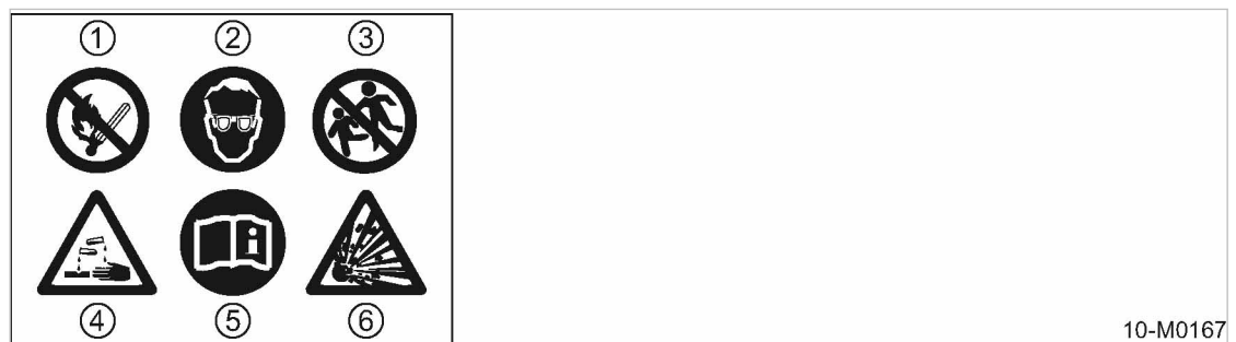
Рис. 34 Наклейка с предупреждающими знаками безопасности на аккумуляторной батарее
